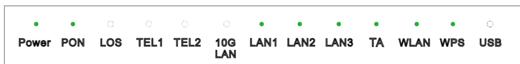
図 4-2 HN8255Ws が外部デバイスへの接続に成功すると点灯する LED
